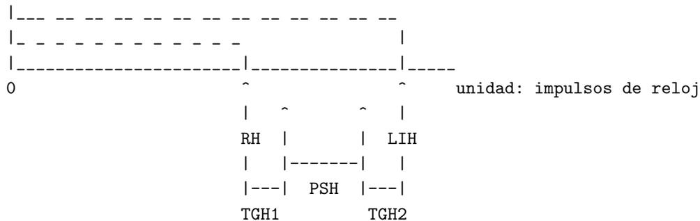
Ahora, nos gustaría colocar un pulso de sincronización de longitud PSH tal y como se explica en el gráfico, por ejemplo, entre el final de los impulsos de reloj para mostrar datos y el final de los impulsos de reloj para toda la imagen. ¿Por qué así?. Porque si podemos hacer esto, entonces su imagen no se moverá a la derecha o a la izquierda. Permanecerá en el lugar de la pantalla donde debe estar, cubriendo perfectamente la zona visualizable de su monitor.
