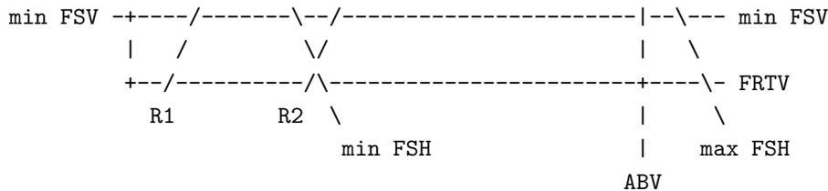
Este es el gráfico de un modo de monitor genérico. El eje de las x del gráfico muestra la tasa de pulsos de reloj (FRTV), el eje de las y representa la tasa de refresco (TR). La región rellena del gráfico describe las capacidades del monitor: cada punto de esta región es un posible modo de vídeo.
